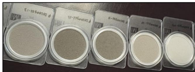
*Figure 5 : Filtres en fibres de quartz (47mm) après prélèvement de 24 heures dans le préleveur gravimétrique PNS18*
