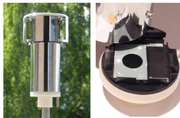
Figure 2 : Illustration du capteur passif de particules  $\text{PM}_{10}$
